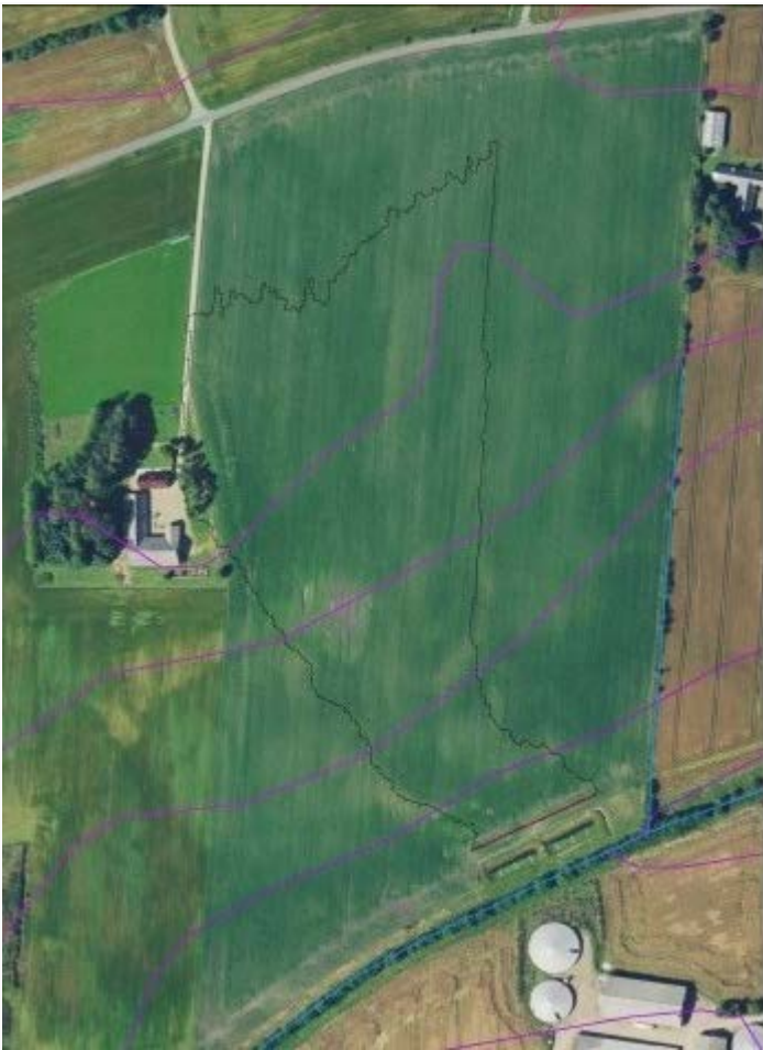
Figur 1: BufferTech forsøgsanlæg ved Spjald med indtegnat (sort) område der leverer overfladisk afstrømning fra mark mod anlæg. (Pink linier er højdekurver og vandløb er blå bånd i forinden i luftfoto hvor anlæg ses som to huller).
